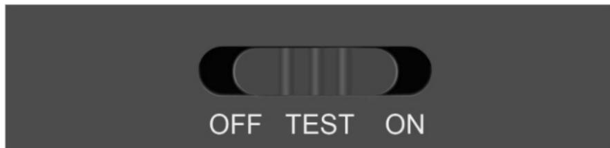
① Переведите ползунок из положения **OFF** в **TEST**, чтобы включить камеру и перейти к её настройке. Вы можете выбрать режим работы устройства, качество фотографий и видеосъемки и др.
